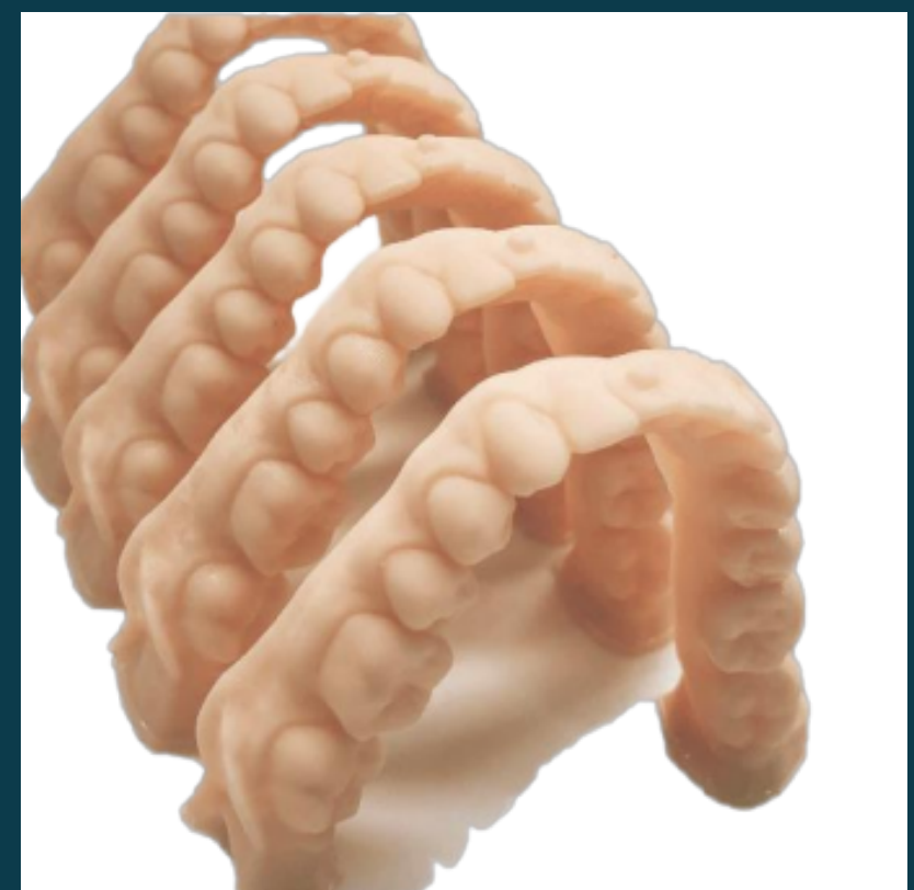
Impressão de modelos em resina líquida
